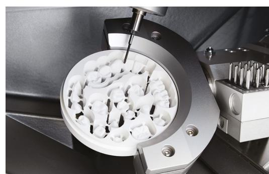
Ein weiteres Novum ist die integrierte Wasserkühlung, die die Wärmeausdehnung von Spindel und Z-Achse deutlich minimiert. Schnellere Bearbeitung mit noch konstanteren Arbeitsergebnissen bei längerer Lebensdauer der Spindellager sind die Vorteile für künftige HinriMill R5-Besitzer.
