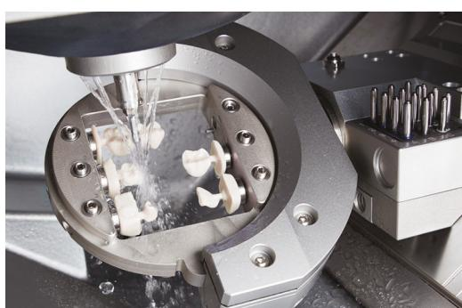
Die Direct Clean Technology sorgt dafür, dass schnell und mühelos zwischen Nass- und Trockenbearbeitung gewechselt werden kann. Hierzu bietet die HinriMill R5 neben Ionisatoren und einer aktiven Arbeitsraumentlüftung auch eine absolut pfiffige Trocknungsfunktion.
